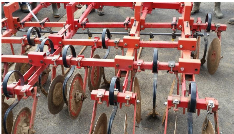
Photo 5 : Bineuse avec les disques couvreur, dents patte d'oie et les skis
