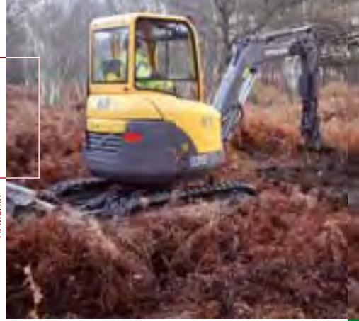
A. Morfin La préparation du terrain avec une mini-pelle équipée d'outils Becker est une des modalités étudiées.
